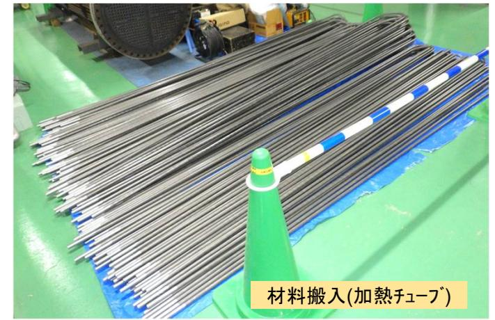
最高使用圧力4Mpa 蒸気発生器チューブバンドルの交換をさせて頂きました
